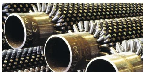
**Materiales:** Tuberías y Birlos (Studd) en aceros al carbón, aceros inoxidables, aceros aleados, aceros de alta corrosión (Alloys, Titanio, Hastelloy), cobre y aluminio entre otros.
